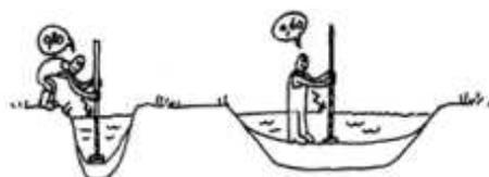
Figure 3 : Mesure de l'épaisseur de la tranche d'eau (Source : FMA, 2003).
