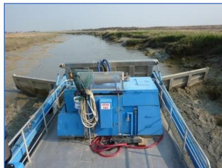
Préalablement au passage du bac dévaseur, un 1<sup>er</sup> passage est effectué à l'aide de la fraise placée à l'avant du bateau pour décompacter la vase et faciliter le travail.
