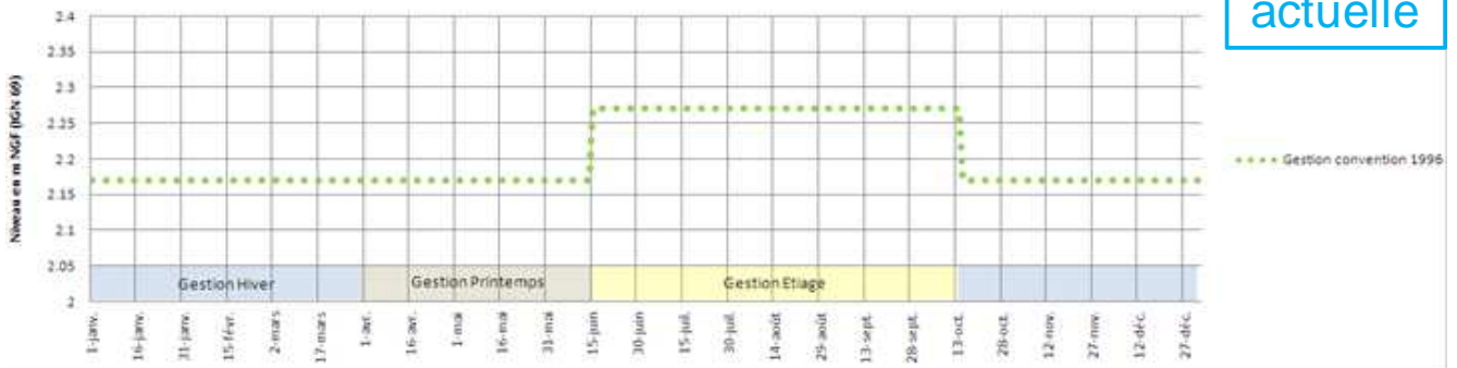
Proposition de principes de gestion des niveaux d'eau en fonction des débits (hors épisodes de crues) - Les Bourdettes - - Décembre 2013
