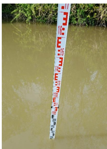
Figure 16 : Prise de mesure de hauteur de lame d'eau dans un canal avec une règle télescopique Source : Photo interne EPMP
