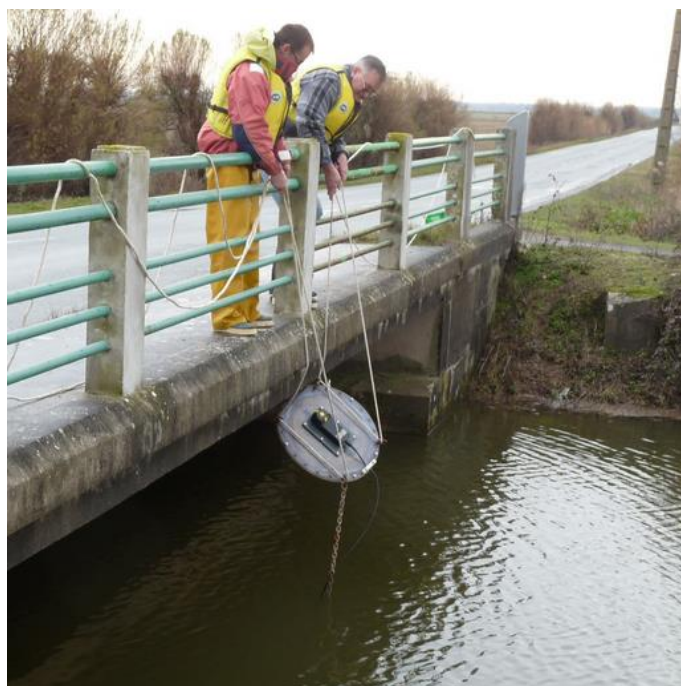
Figure 8. Mise en place du courantomètre Argonaute SonTek sur le chenal du Curé (Ifremer/LERPC).
