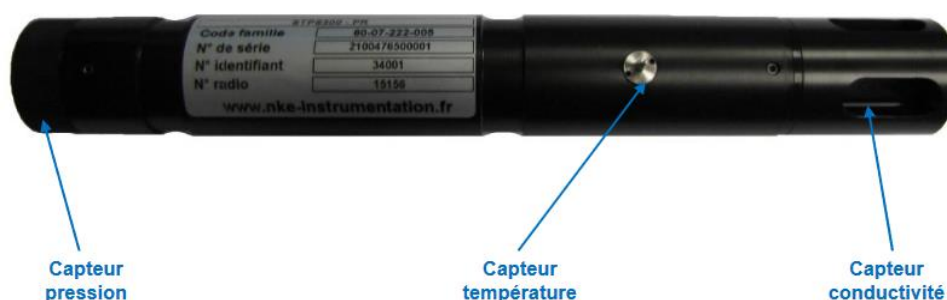
Figure 3. Sonde STPS NKE Instrumentation® déployée sur chacun des sites pour les mesures in situ continues de température, pression et salinité.
