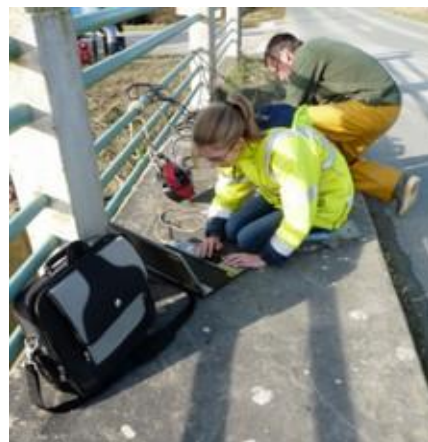
Figure 7. Installation initiale sur le fond, Janvier 2017 chenal du Curé : Armoire de protection de la batterie externe (gauche) et opération de paramétrisation par connexion filaire (droite).
